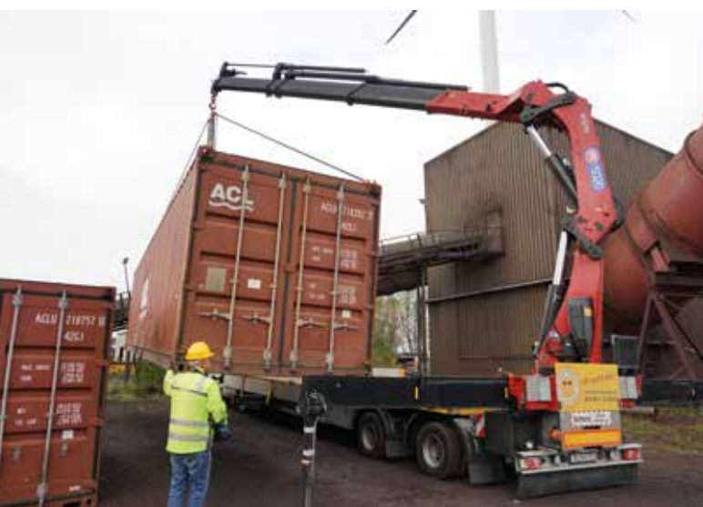
Der Knickarmkran mit vier Ausschüben bietet ein Einbaumaß von gerade einmal 1.198 mm.
