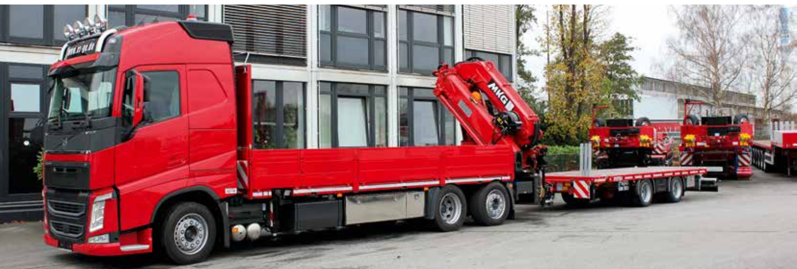
Hier mit heckseitig montierte MKG-Ladekran – kombiniert mit einem Volvo.
