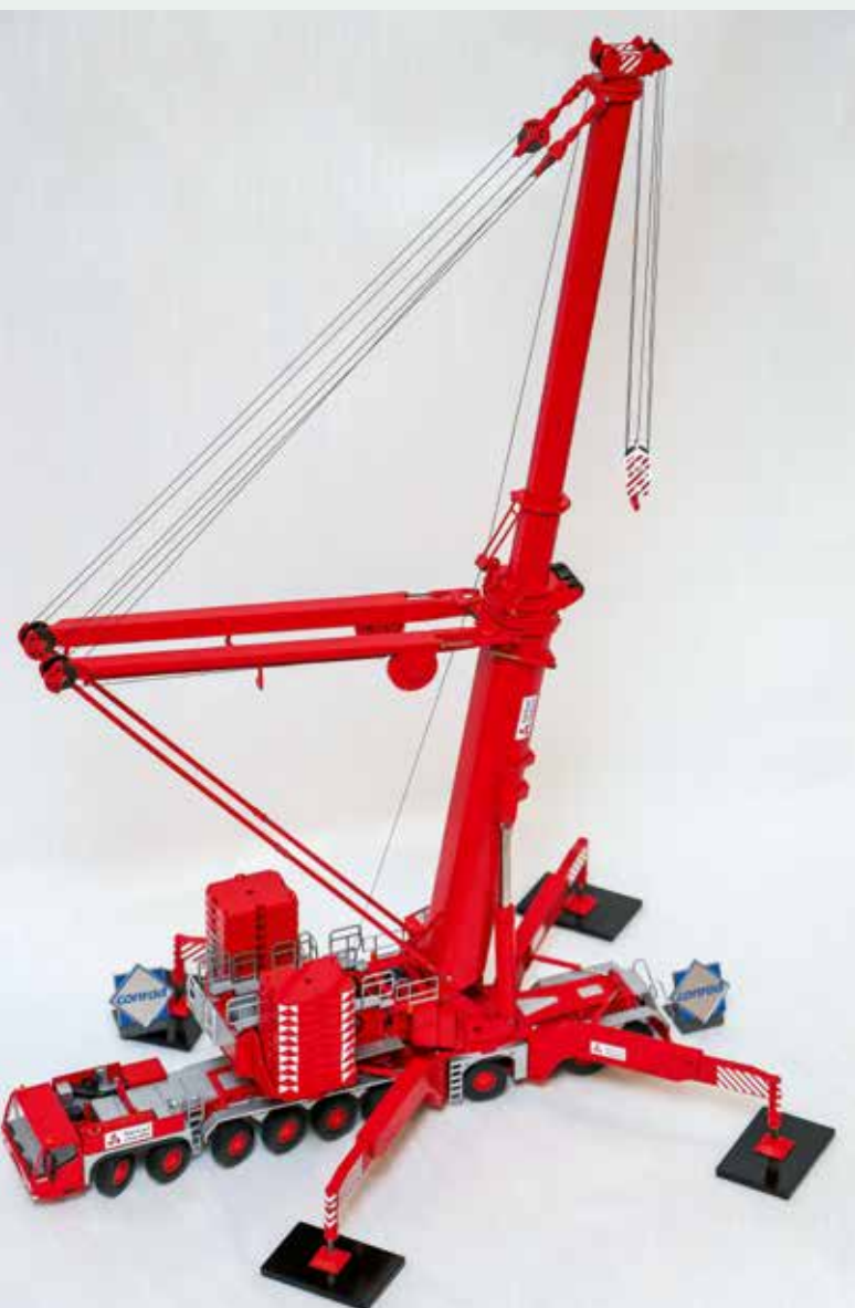
Aufballastiert und mit Superlift-Einrichtung ....
