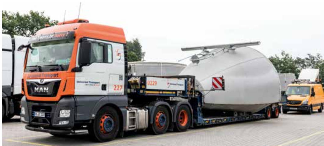
Universal Transporte brachte die Komponenten einer getriebelose Windenergieanlage des Typs E-82 in den Windpark.
