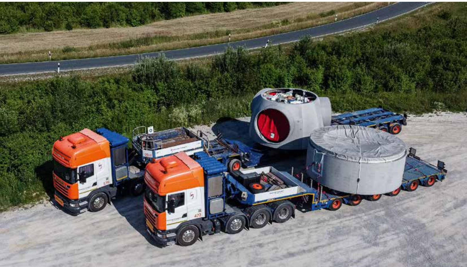
Nabe und Turmsegment stehen zur Entladung bereit.
