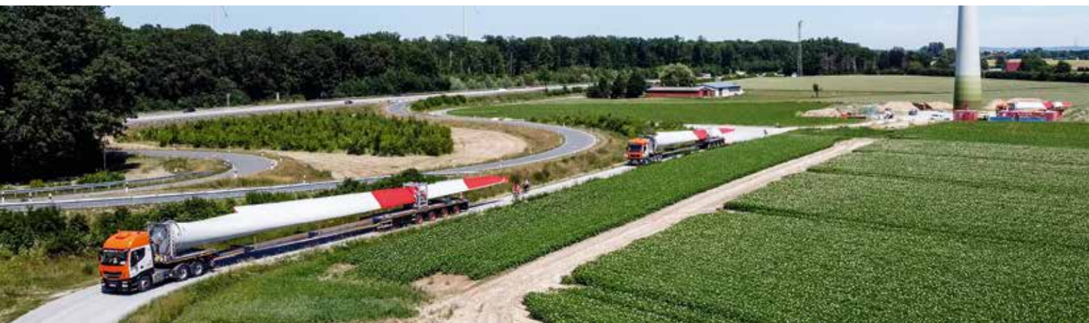
Universal Transporte brachte die Komponenten einer getriebelosen Windenergieanlage des Typs E-82 in den Windpark.
