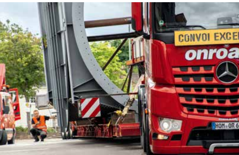
Passt die Bodenfreiheit? Anweisungen an den Fahrer per Funk.
