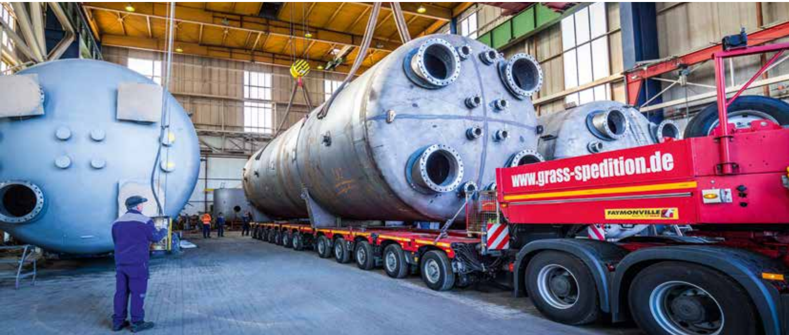
88 t und 105 t brachten die Tanks auf die Waage.
