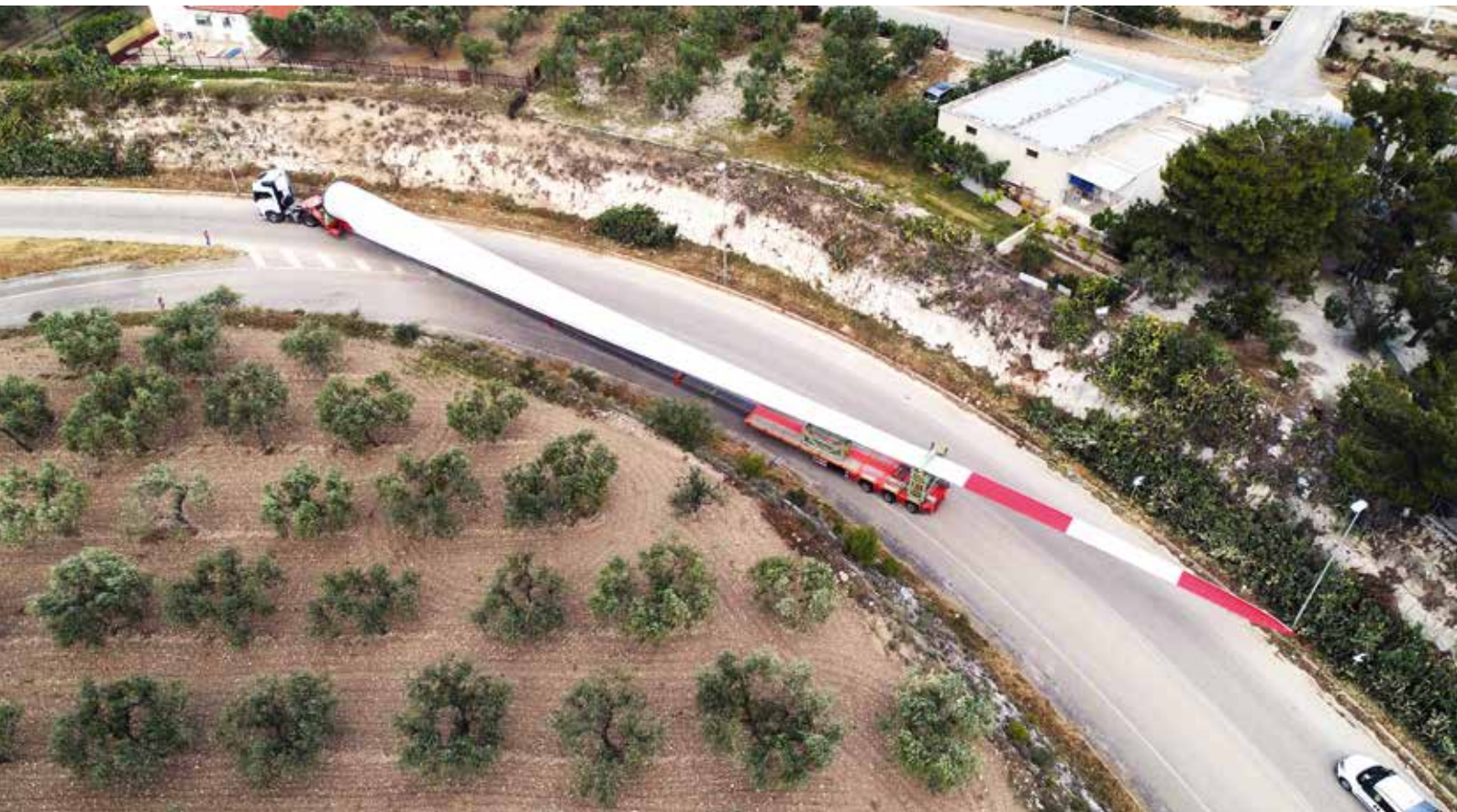
Zum Transport von Rotorblättern von mehr als 70 m Länge bietet Faymonville jetzt den WingMAX.
