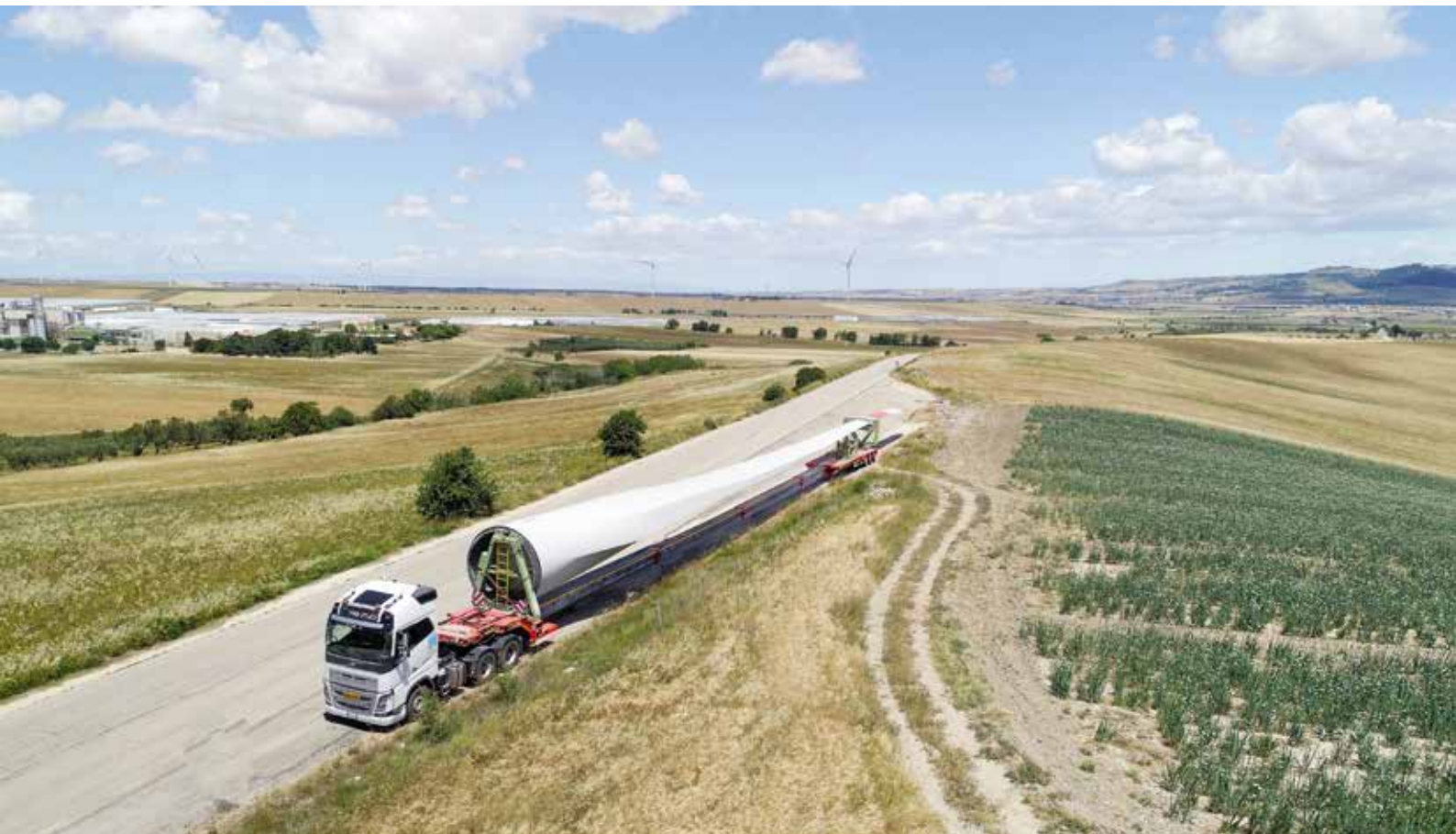
Der WingMAX ist ausgelegt für den Einsatz mit 4- und 5-Achs-Sattelzugmaschinen.
