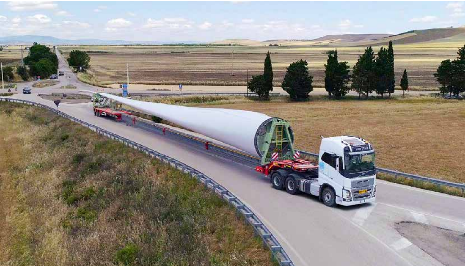
Der Schwanenhals des WingMAX bietet einen Hub von bis zu 1.700 mm.
