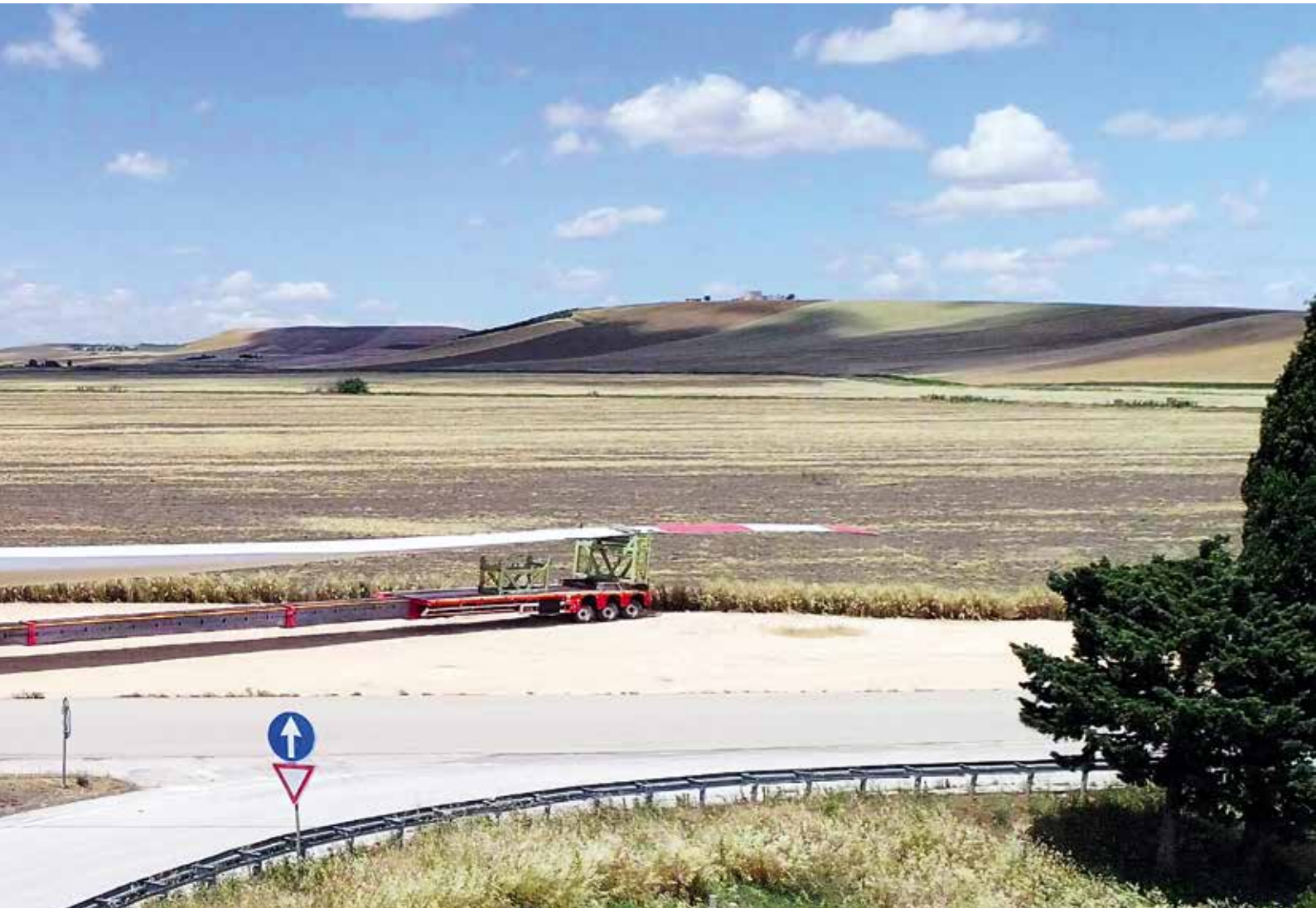
Zum Transport von Rotorblättern von mehr als 70 m Länge bietet Faymonville jetzt den WingMAX.
