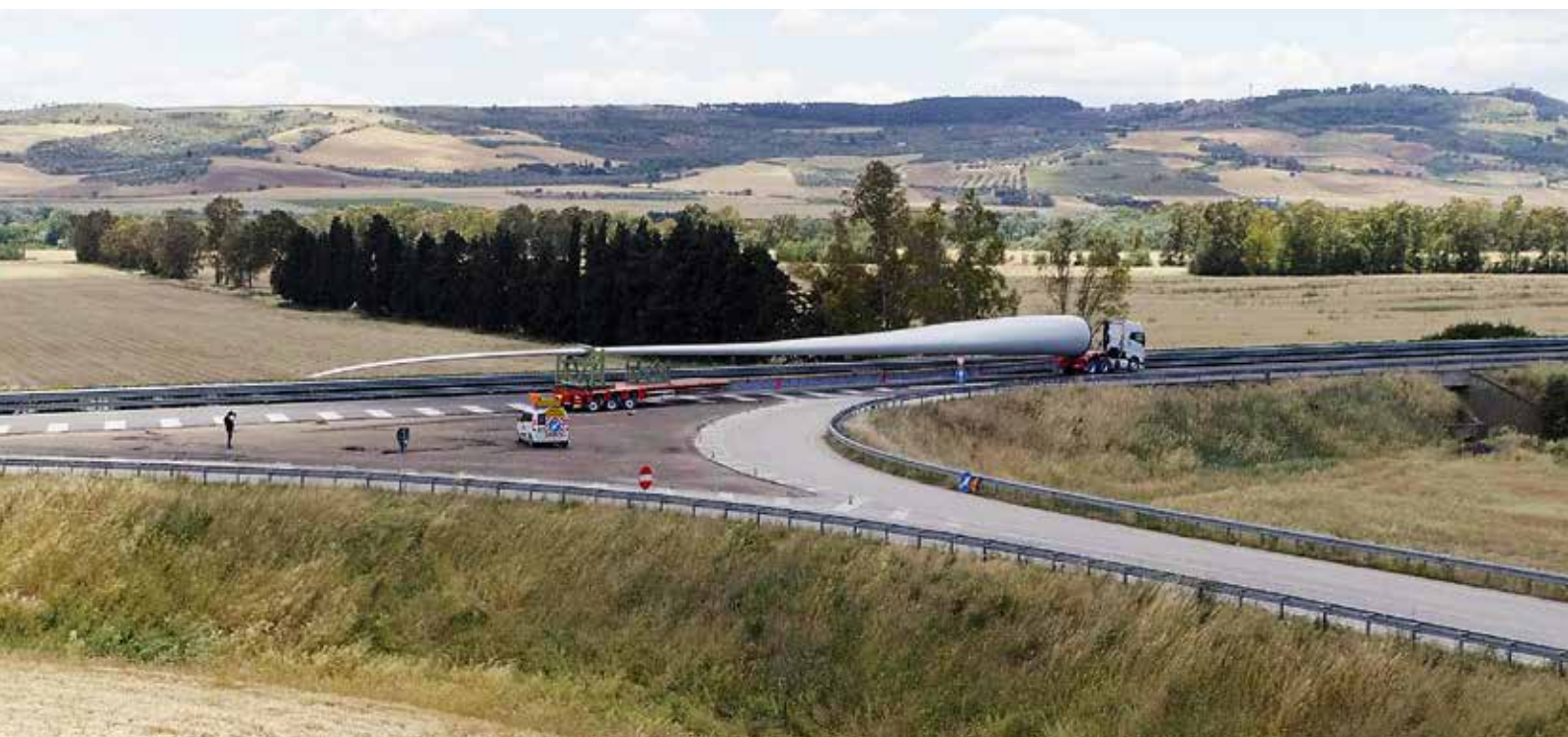
Eine verschiebbare Lastaufnahme für das Flügel-Tippgestell bietet die Möglichkeit, den Auflieger auch unter Last zu verkürzen.
