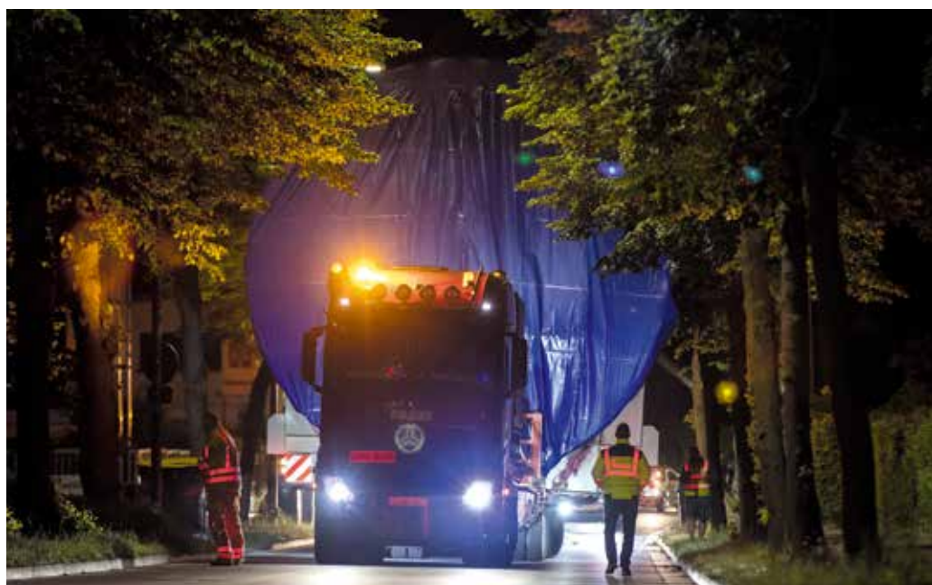
175 t Gewicht bei einer Länge von 25 m, einer Breite und Höhe von rund 7 m bringt dieser Autoklav auf die Waage.
