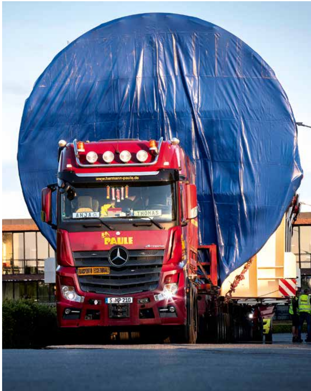
175 t Gewicht bei einer Länge von 25 m, einer Breite und Höhe von rund 7 m bringt dieser Autoklav auf die Waage.
