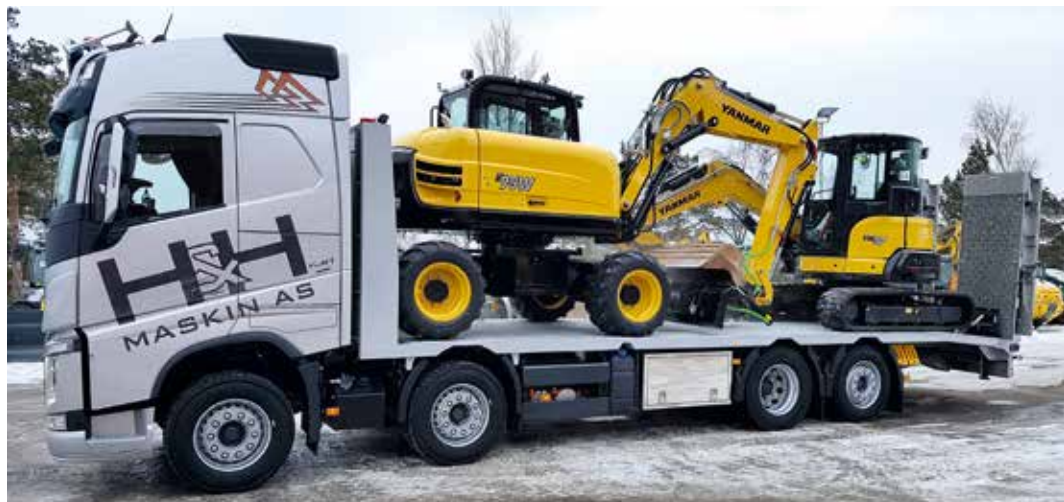
Ein Plattformaufbau von Bickel Tec im Einsatz.
