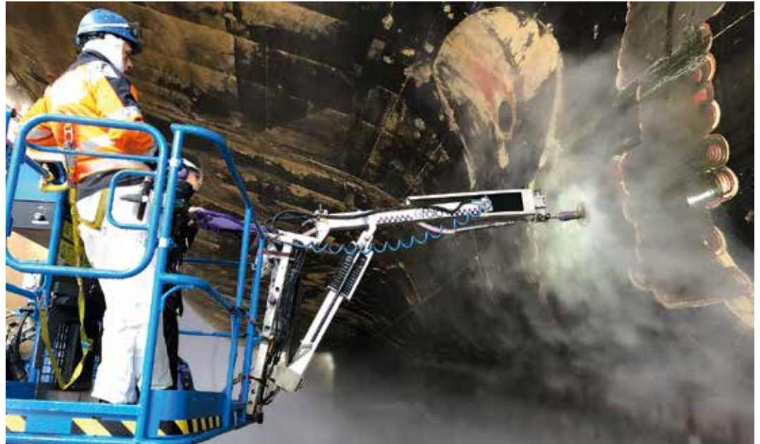
Der falch multi worker montiert an einer Genie SX 135 XC Teleskoparbeitsbühne beim Einsatz.
