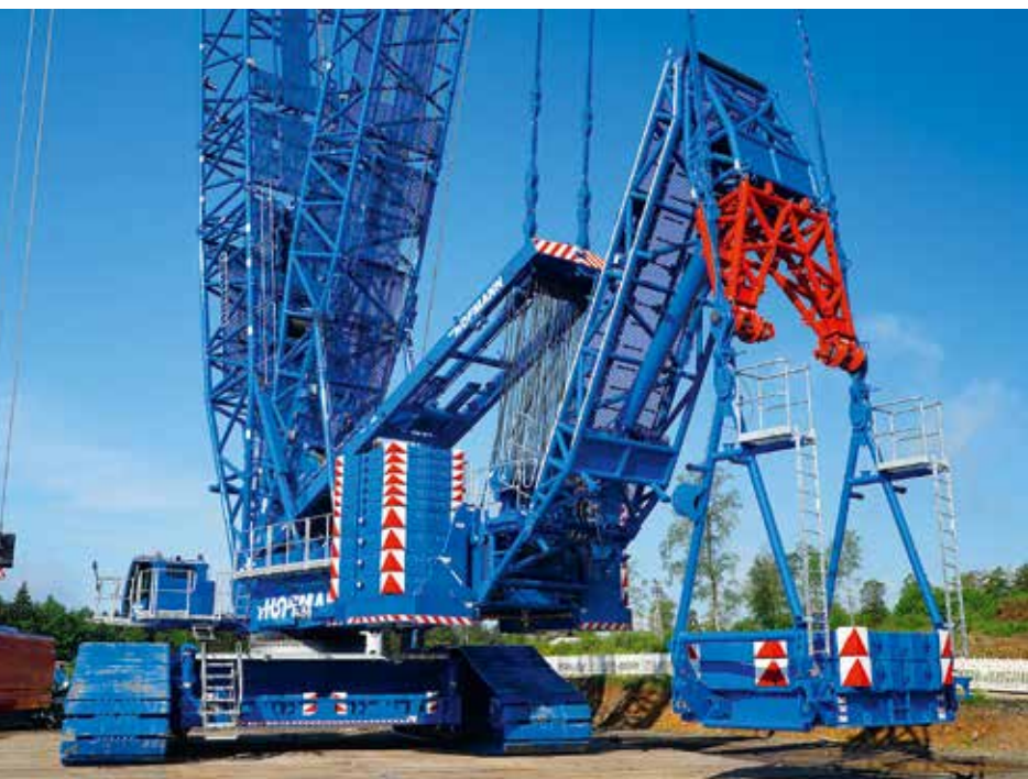
VarioTray mit leichter Ballastierung für die Hübe.
