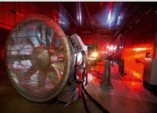
Die Anlage ermöglicht Temperaturen von -48 Grad C bis +51 Grad C.
