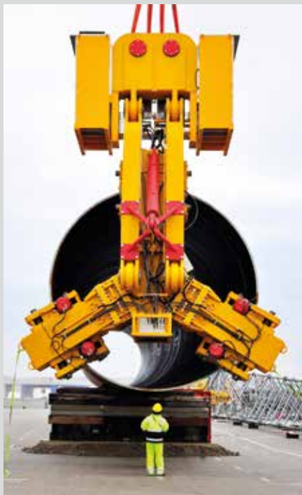
Upending-Tool beim Handling von Monopiles.
