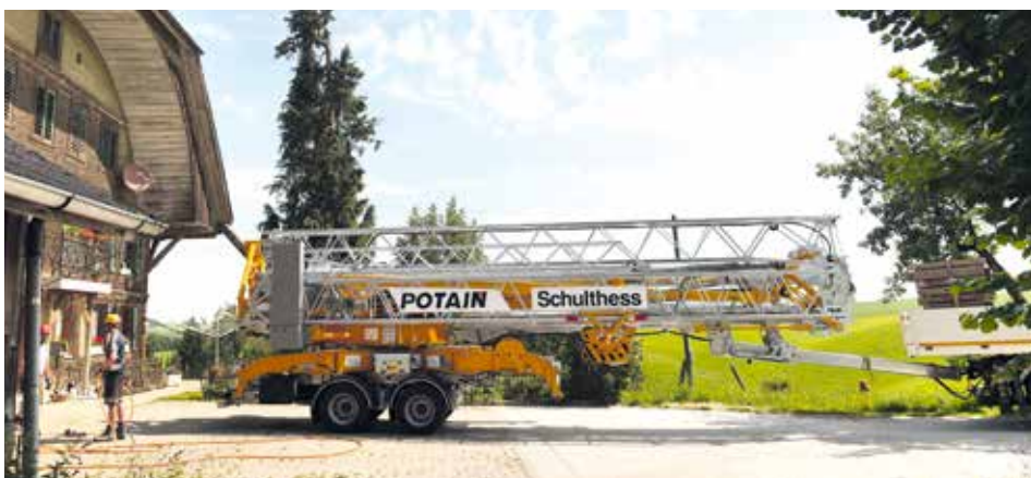
Mit einer Länge von 11,6 m und einer Höhe von 3,6 m bietet der Hup M 28-22 ein kompaktes Transportformat.
