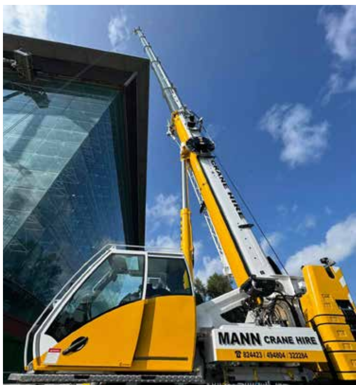
Der GMK3060L-1 ersetzt Glasplatten im Kraftwerk Pulrose auf der Isle of Man.
