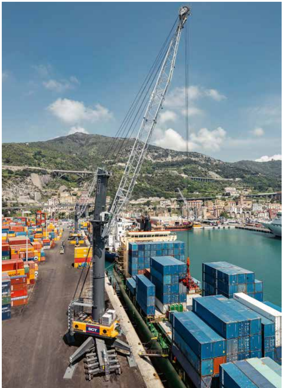
Der LHM 600 High Rise hat einen höheren Anlenkpunkt, so dass auch größere Schiffe und Containerreihen bedient werden können.
