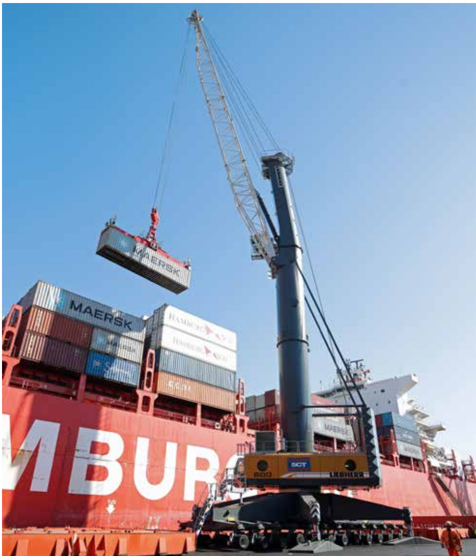
Dank der höheren Kabine von 37,1 Metern profitieren die Kranführer von einer besseren Sicht auf Ladung und Container.
