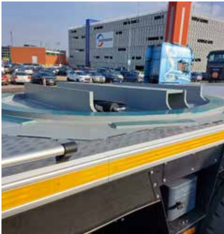
Tadano Fahrgestell, 7-achsig für Kobe Japan. Dort werden die Oberwagen montiert.
