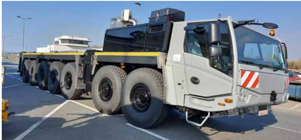
Tadano Fahrgestell, 7-achsig für Kobe Japan. Dort werden die Oberwagen montiert.
