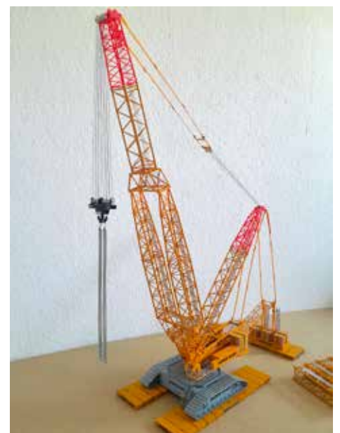
Der Kran in der kürzesten Aufbauvariante mit Powerboom.
