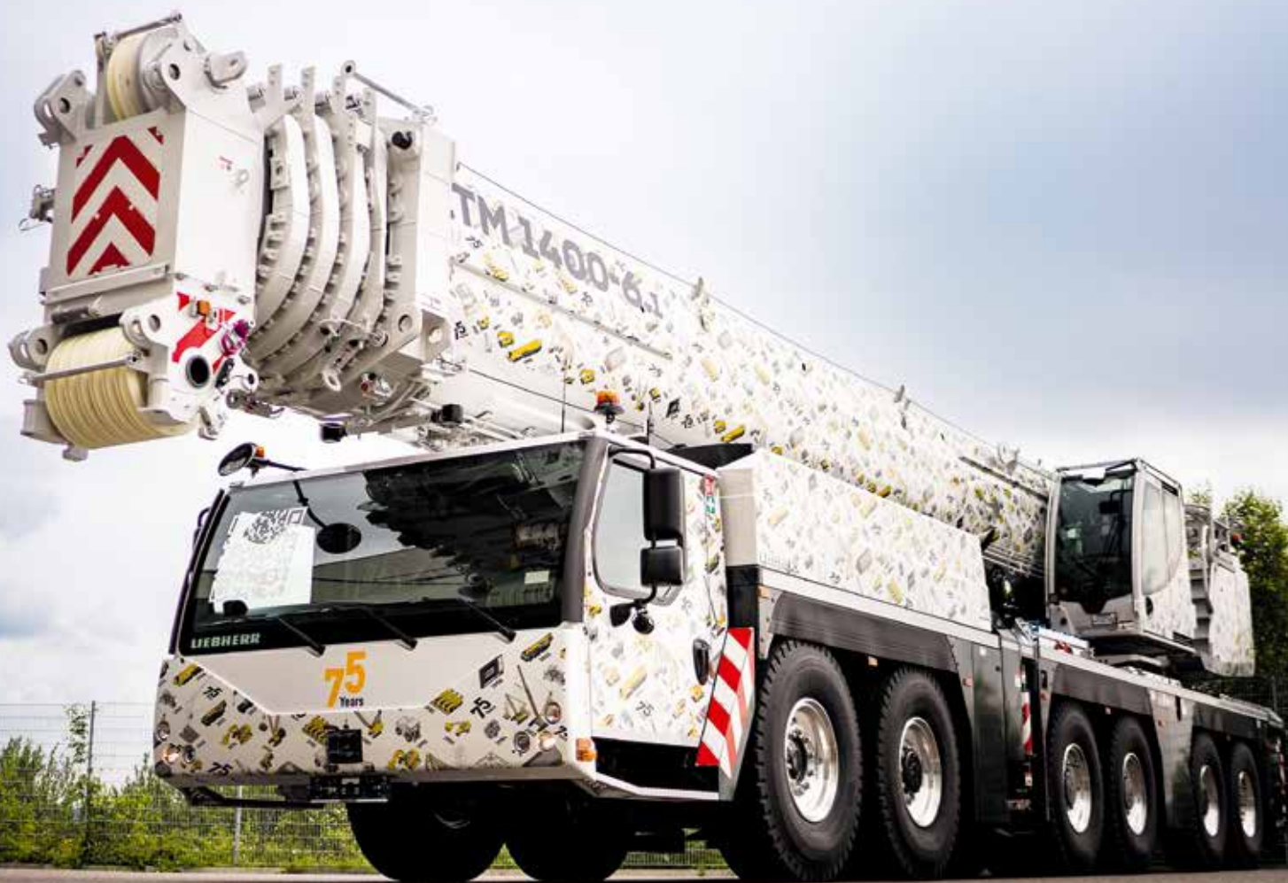
Der neue Liebherr LTM 1400-6.1 zeichnet sich durch starke Tragkräfte und seinen 70 Meter langen Teleskopausleger aus.
