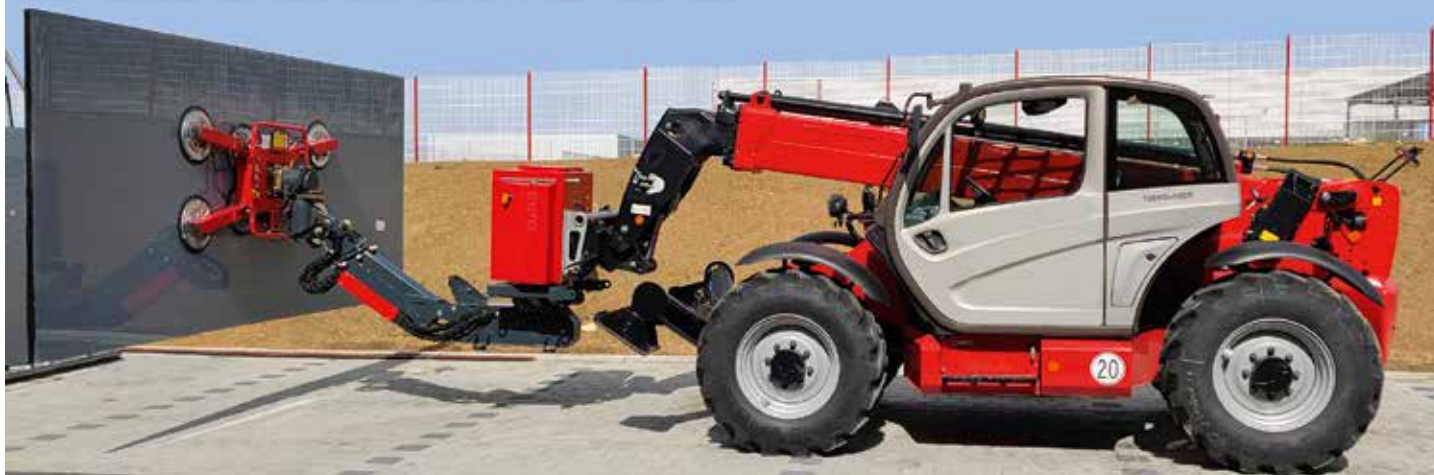
Innovation aus der Vakuumtechnik: Der Litocran von euroTECH.
