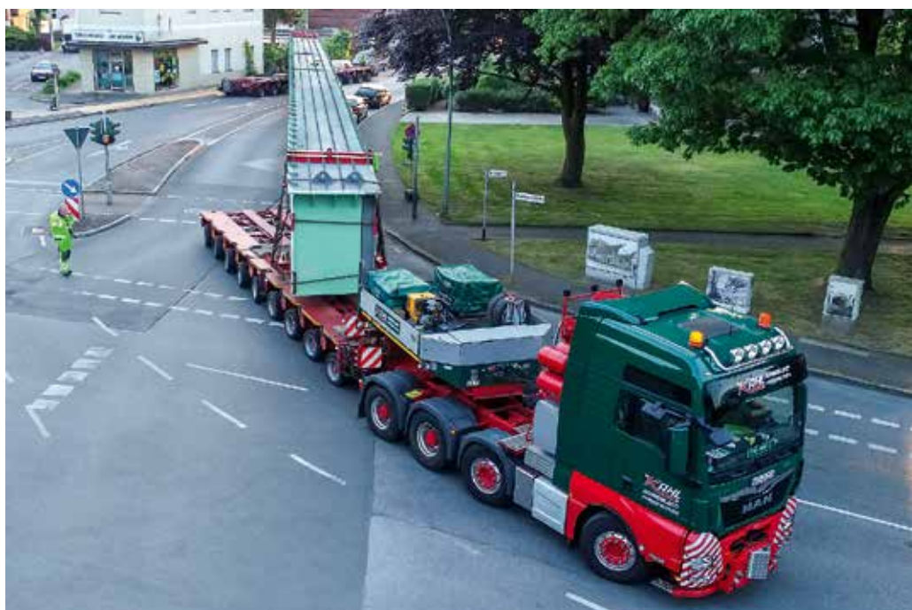
Auf eine Länge von 58 m brachten es die Brückenträger.
