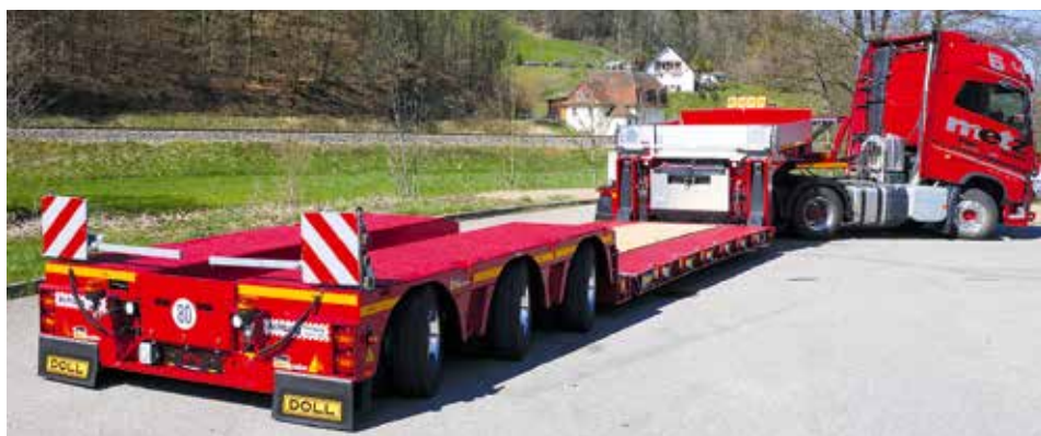
Von Doll bekam Metz Bagger & Transporte eine Kombination aus 3-Achs Tiefbett und 1-Achs Dolly geliefert.
