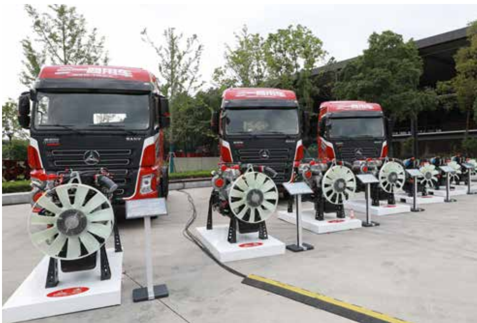
Der „Kingway 435“ von Sany ist mit einem 360 kW leistenden D12-Motor von Deutz ausgerüstet.
