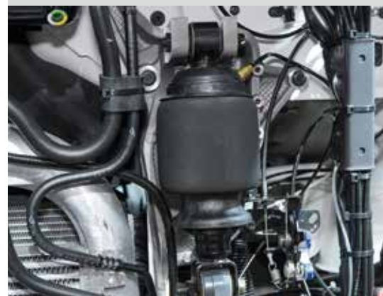
HiTemp-Luftfedern dämpfen Lkw-Kabinen auch unter Extremtemperaturen zuverlässig.
