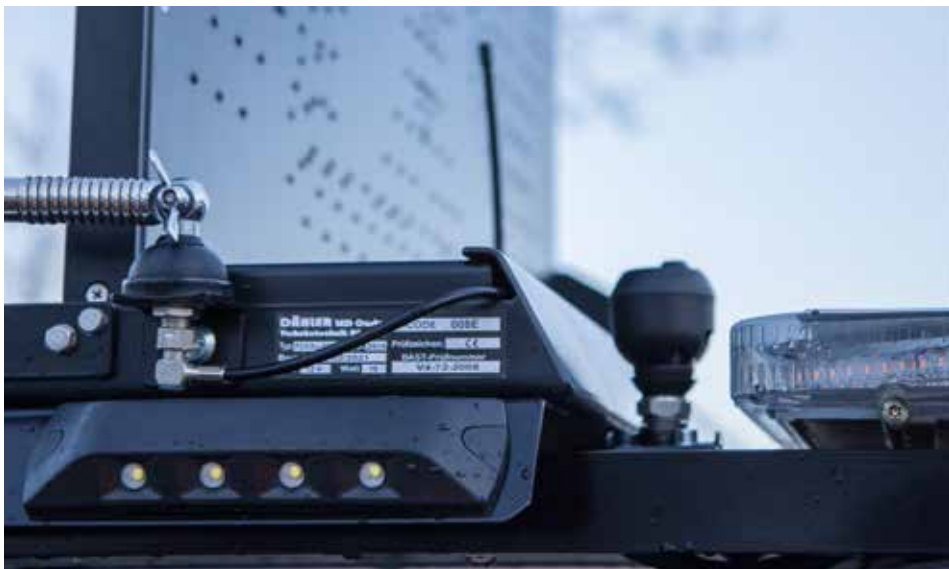
Neben dem Dachlichtbalken sind Funkantennen und Höhenmessgerät eingebaut.
