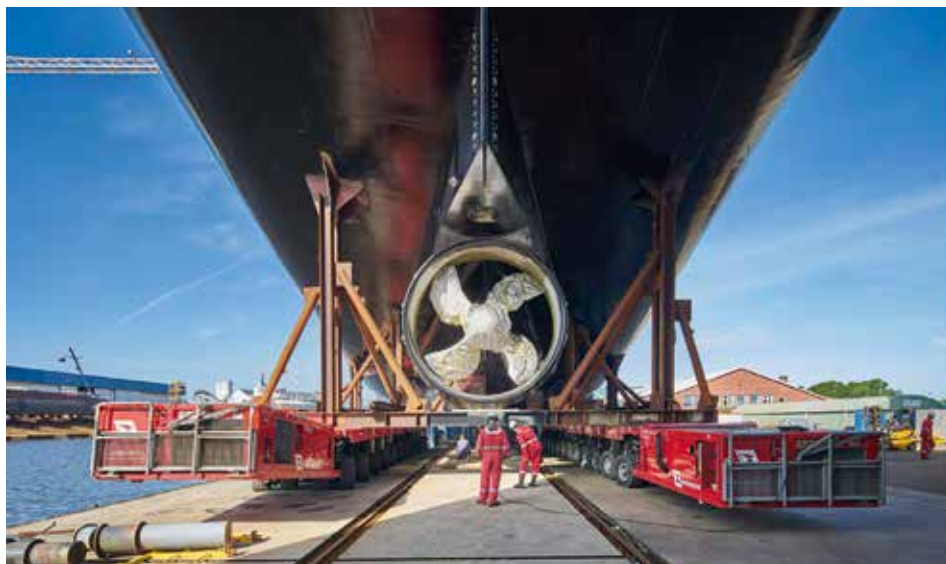
Wagenborg Nedlift überzeugte die Jury in Kategorie 10 mit zwei 12-Achs-SPMT-Linien mit Powerpacks.
