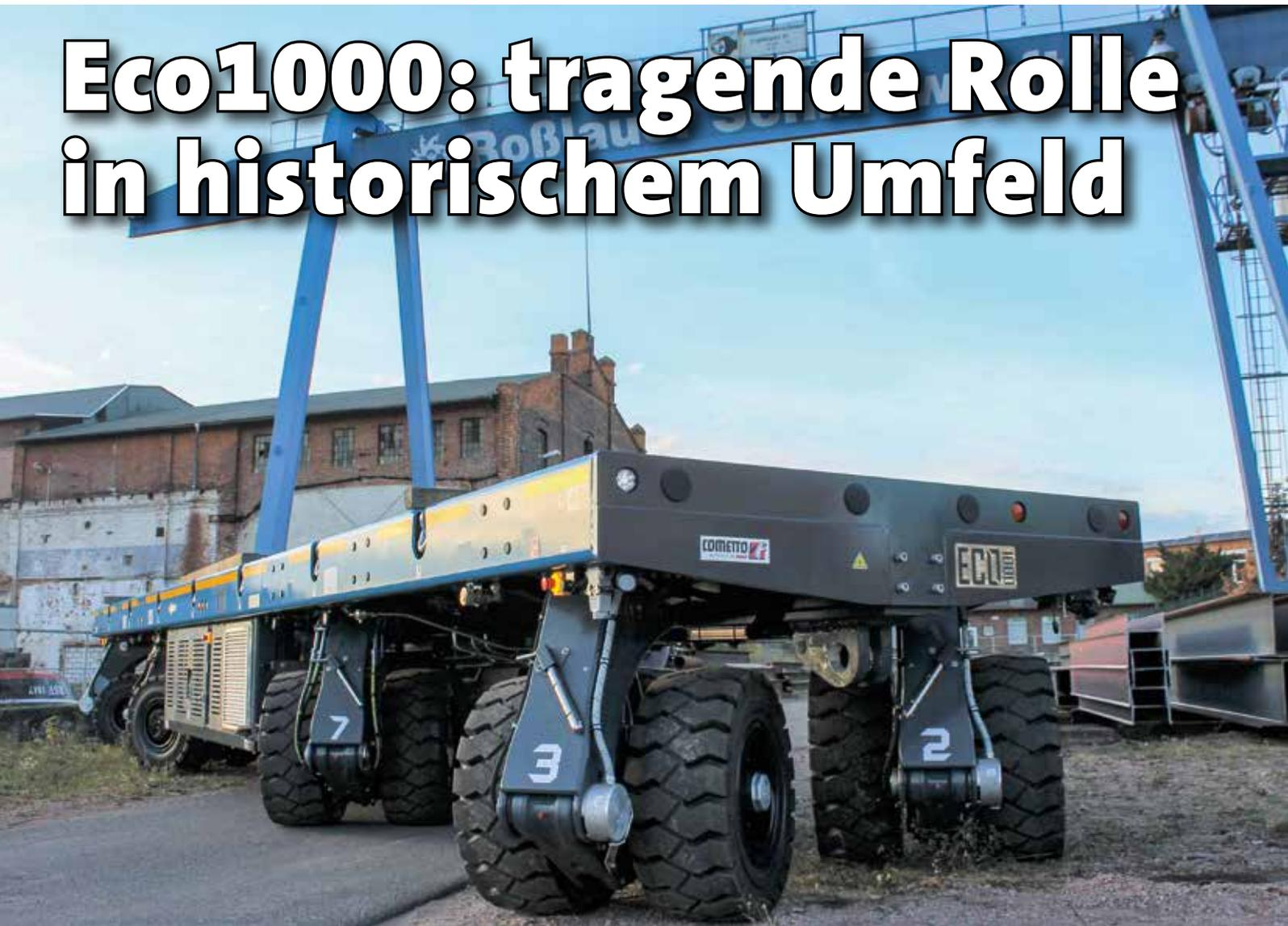
Für den innerbetrieblichen Verkehr kommt bei der Roßlauer Schiffswerft nun ein Cometto Eco1000 zum Einsatz.
