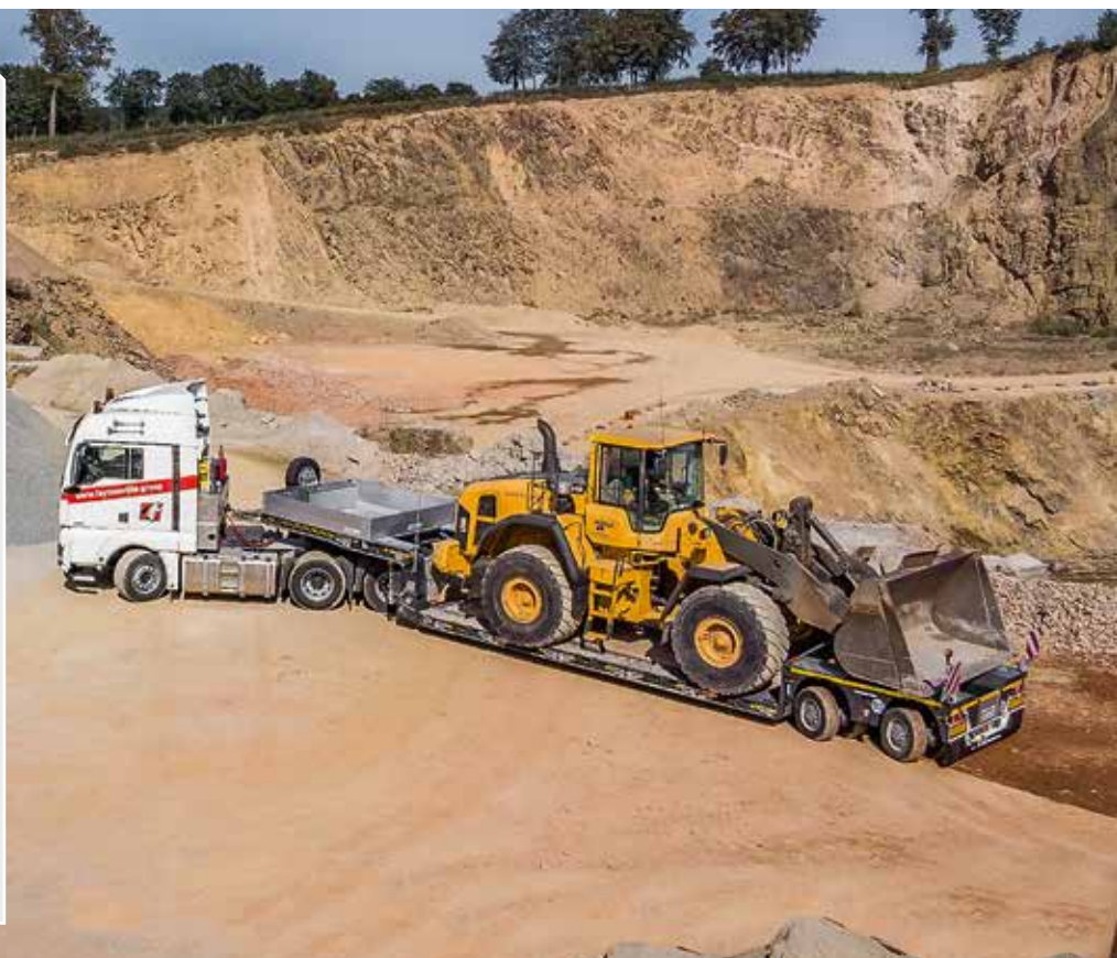
Typisch Pendelachse: Der Lenkeinschlag von bis zu 60° verleiht der Transportkombination optimale Manövrierbarkeit.
