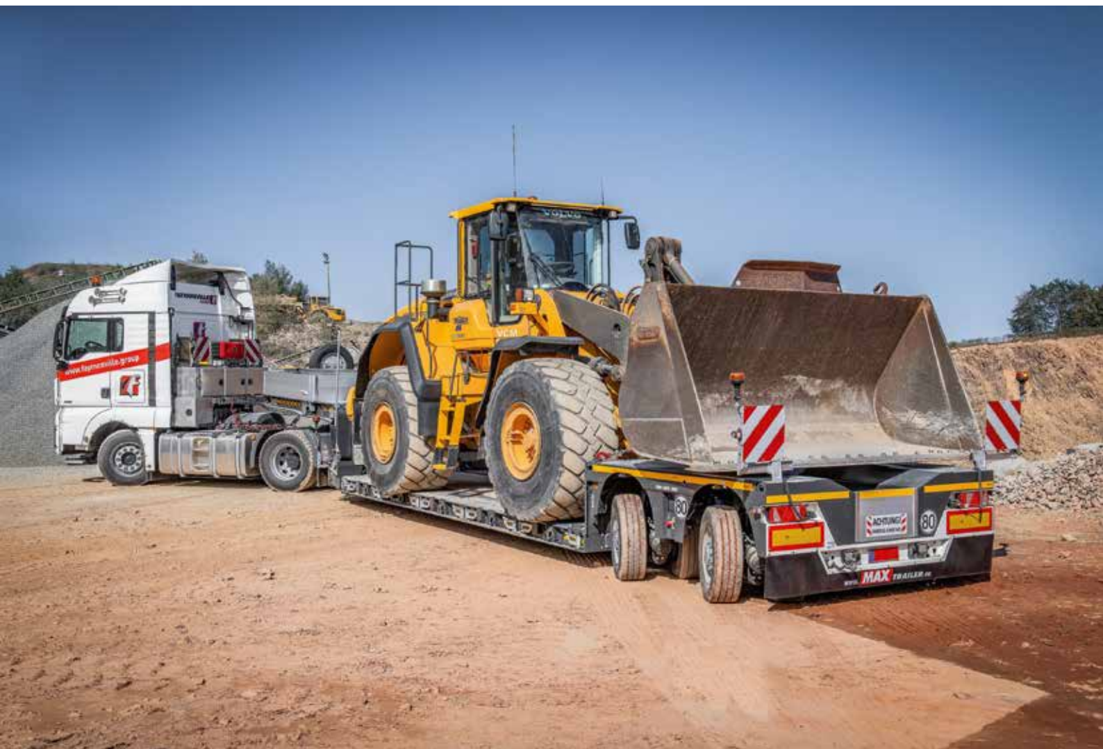
Typisch Pendelachse: Der Lenkeinschlag von bis zu 60° verleiht der Transportkombination optimale Manövrierbarkeit.
