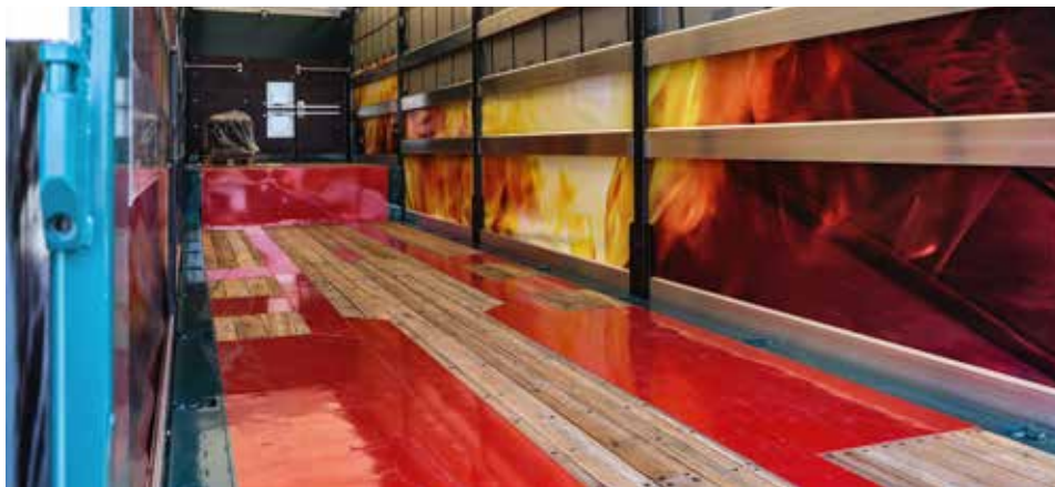
Die zum Teil mit einem Hartholzboden belegte Ladefläche eignet sich für hohe Punktlasten.
