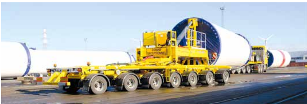
... sowie einem 7-achsigen Nachlauf-Dolly. Beide Dollys verfügen über einen hydraulisch einstellbaren Liftadapter.
