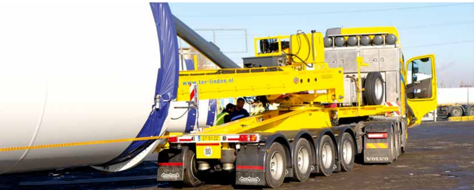
Das niederländische Unternehmen Ter Linden Transport hat den ersten neuen Mega Windmill Trailer XL (MWT-XL) von Nootboom erhalten. Dieser besteht aus einem 4-achsigen Jeep-Dolly ...
